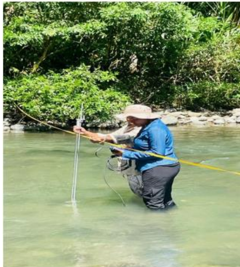
Foto 3. Medición de caudal con el OTT MF Pro
