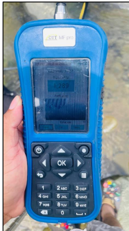
Ilustración 5. Caudal Instantáneo en foro usando el MF Pro.
