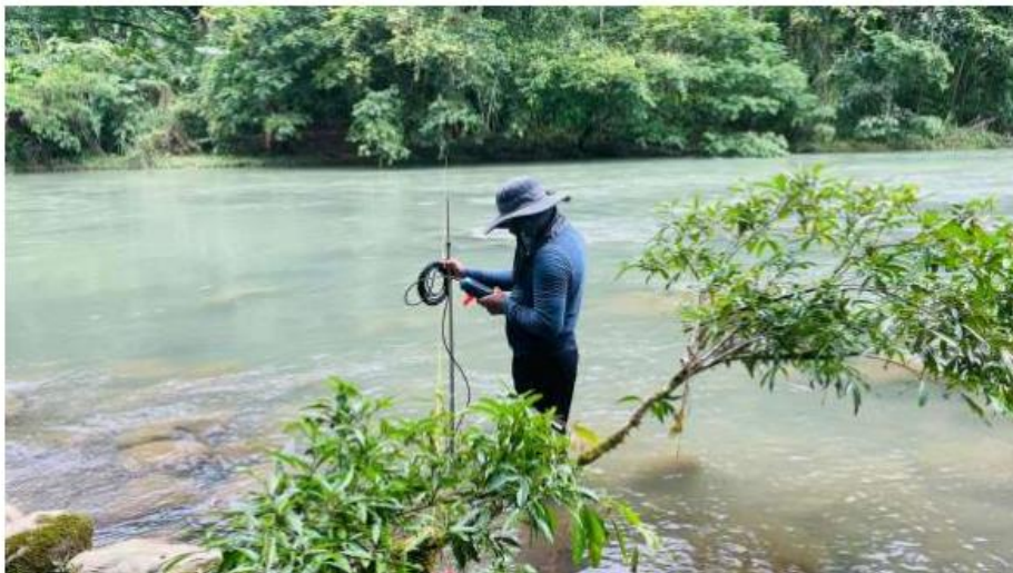
Foto 3. Medición de caudal con el OTT MF Pro
