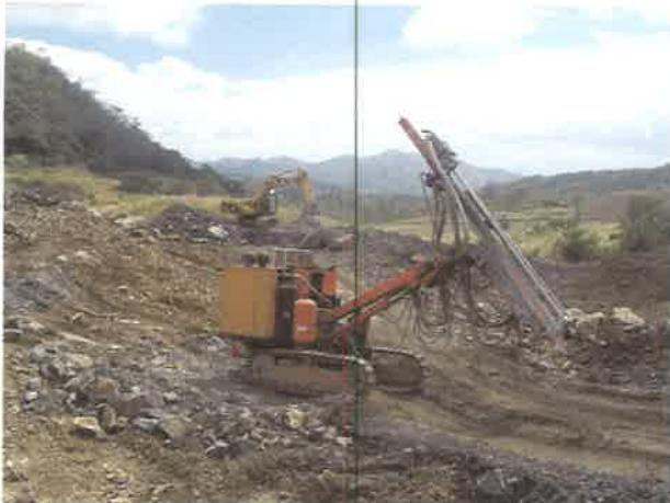
PERFORACIÓN DE BARRENOS Y CARGA DEL MINERAL EN EL FREnte DE EMPLAZAMIENTO
