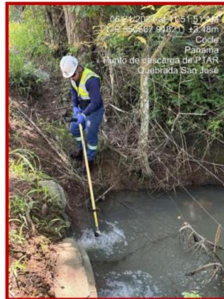
Fig. 3 Medición de parámetros de campo en el Punto de descarga de PTAR Quebrada San José
