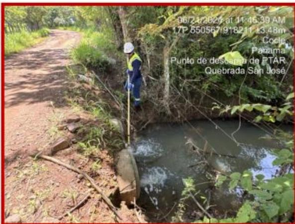
Fig. 2 Toma de muestra en el Punto de descarga de PTAR Quebrada San José
