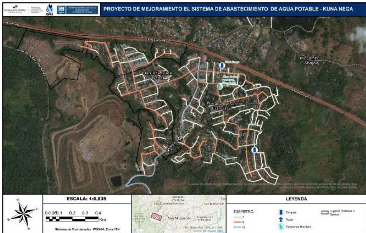
Imagen N°8: Propuesta de trazo de la red de distribución. Con esta distribución de líneas tenemos las siguientes longitudes aproximadas. Tubos de 100 mm: 6,130 m Tubos de 76 mm: 12,912 m Fuente: Promotor
