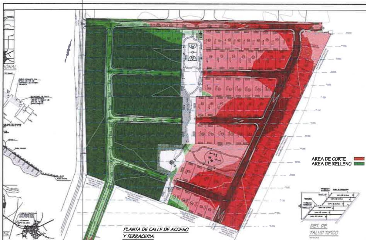
La hoja No. 5 de 19, donde se muestra el cuadro acumulativo de corte y relleno del diseño establecido, se observa que el volumen de corte acumulado es de  $54,983.12 \text{ m}^3$ , mientras que el volumen de relleno acumulado es de  $40,122.91 \text{ m}^3$ , siendo el volumen de corte levemente mayor al del relleno.
