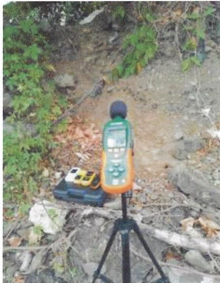
Figura 1. Sonómetro durante la medición de ruido.
