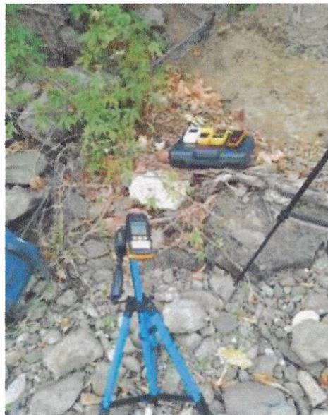
Fig. 2. Medidor de partículas durante la medición de calidad de aire.
