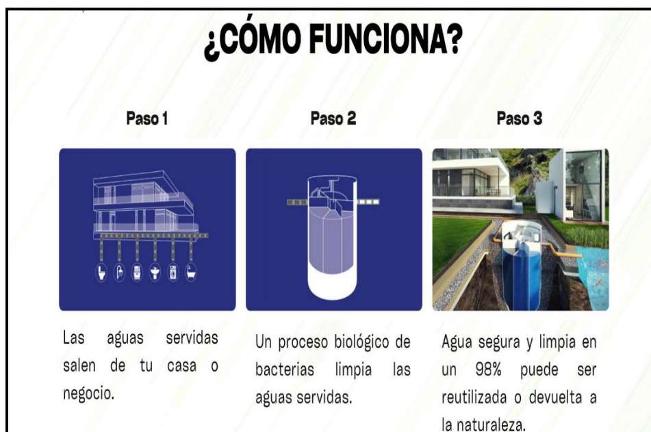
Figura 10. Esquema del proceso de purificación del Tanque purificador biológico AUGUST AT15.
