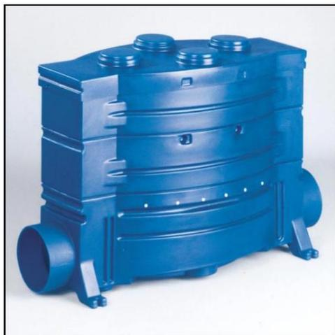
**DIMENSIONES**, • 353 /4" de largo, 141 /2" de ancho, 24" de altura del cuerpo **ESTÁNDAR** • Cuatro tubos de alimentación de productos químicos, 221 /2" de altura • Placas de vertedero de salida intercambiables de 1", 2" y 3" • Conectores de entrada y salida moldeados de 6" **COMPONENTES** • Deflector de entrada ajustable • Dos puntales de seguridad/refuerzo **OPCIONES** • Compuerta ajustable opcional • Soportes de montaje opcionales
