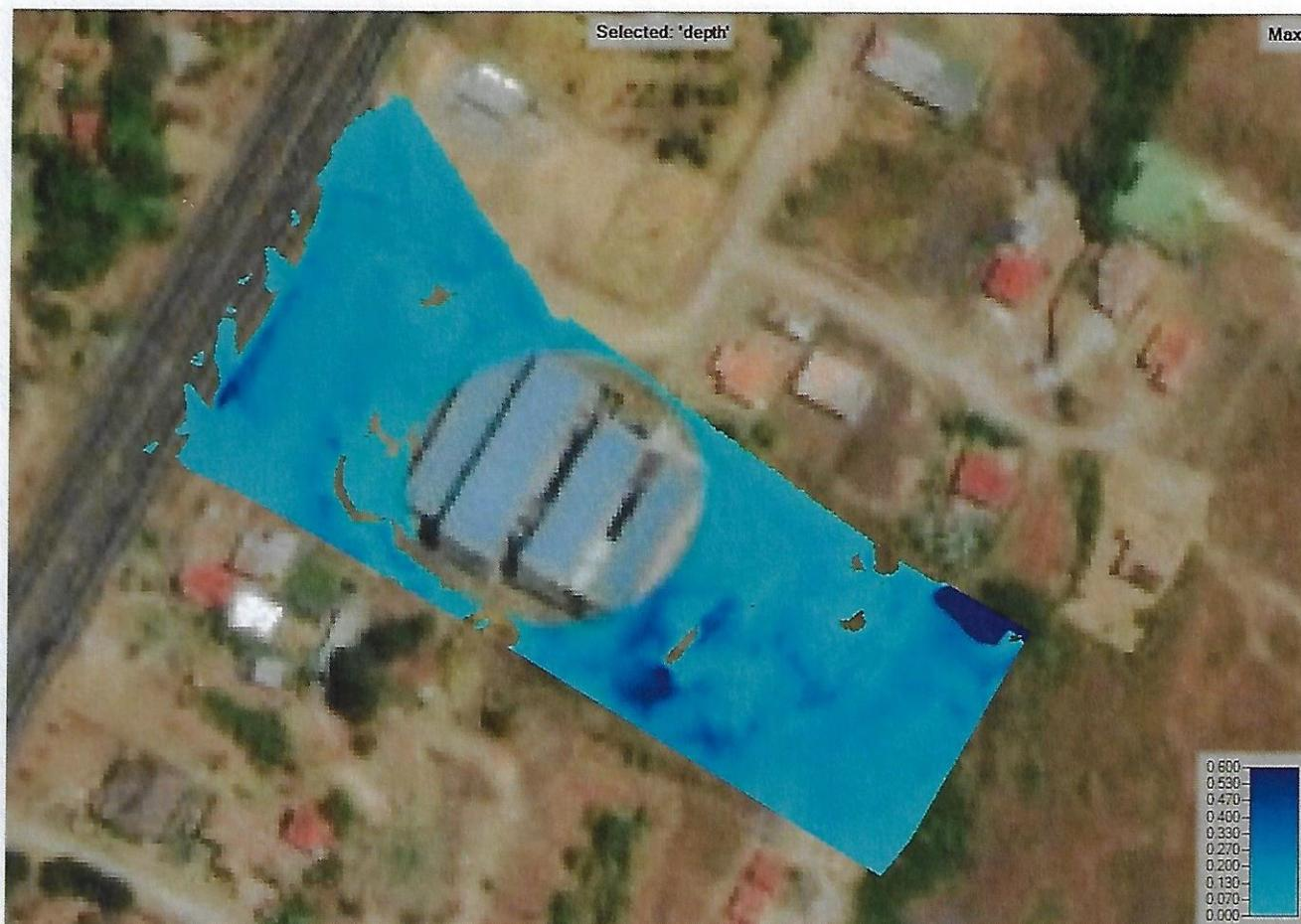
figura 15: Planicie de escorrentía con tirantes de diseño (no incluye tirantes de quebrada)
