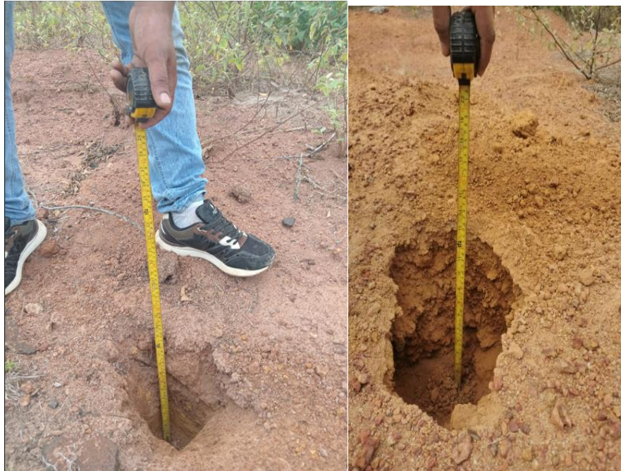
Imagen N° 22: 4 a la.17. Prospecciones realizadas de 7 cm de diámetro y 30 cm de profundidad.
