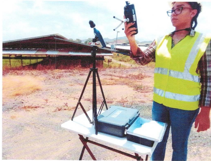
Equipo utilizado y Monitoreo de calidad de Aire Ambiental (PM10), dentro del área del proyecto
