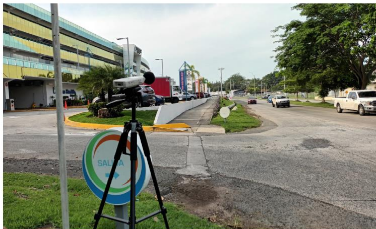
Podemos observar la ubicación del Sonómetro durante el Monitoreo de Ruido Ambiental, en el punto RA-01.
