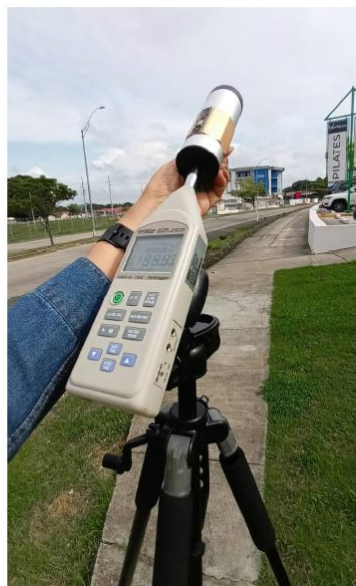
Vista del instante en que se efectuaba la calibración del equipo de medición en el sitio.
