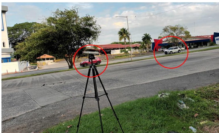
Se pueden observar las diferentes fuentes generadoras de ruido en el sitio donde se localizaba el punto RA-01 durante la medición de ruido ambiental.
