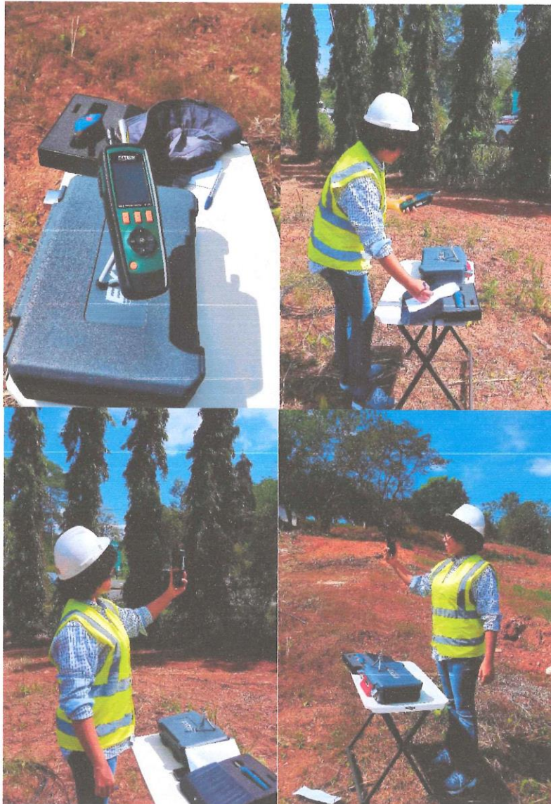
Equipo utilizado y Monitoreo de Calidad del Aire (PM10) dentro del área del proyecto
