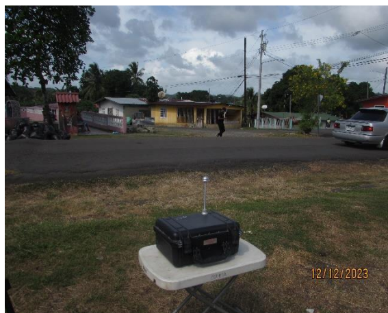
Imágenes 14.8.1. Vista del equipo durante la medición de PM_{10} en el Punto 1. Comunidad de Cuipo, cerca del parque
