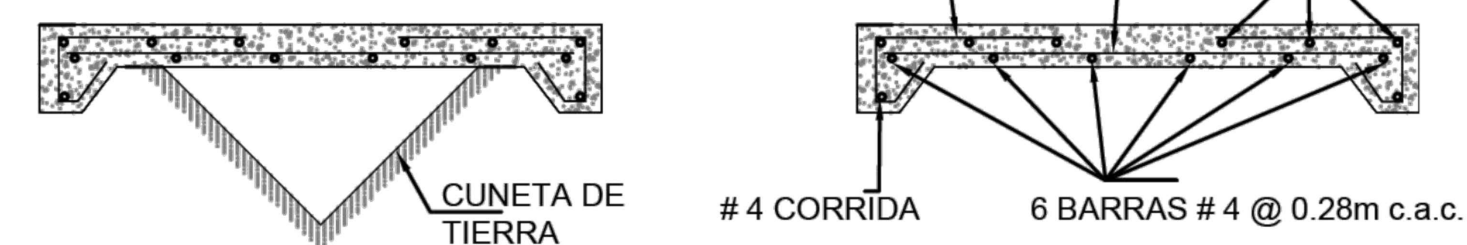
PLANCHAS DE HORMIGÓN DE 1.25m X 1.60m X 0.12m PARA PASAR AUTOS PERSONALES Y PEATONES SOBRE CUNETAS PAVIMENTADAS
