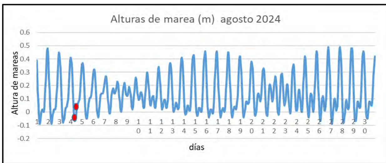
Figura 3. Corrido de la onda de marea correspondiente al mes de agosto 2024, puntos rojos mediciones Lagrangianas.
