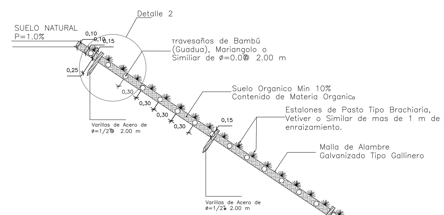
Control Vegetal en Taludes de Pendientes Superiores de 1.0V : 1.5H
