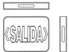
DETALLE TÍPICO DE SEÑAL LUMINOSA DE SALIDA 1. DIMENSIONES DE LETRAS DE ACUERDO A NFPA 101.
