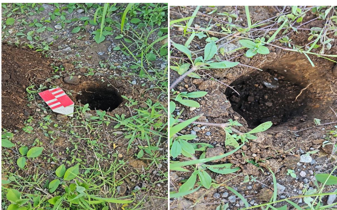
Fotos 3, 4. Excavación y caracterización de pozo de sondeo.
