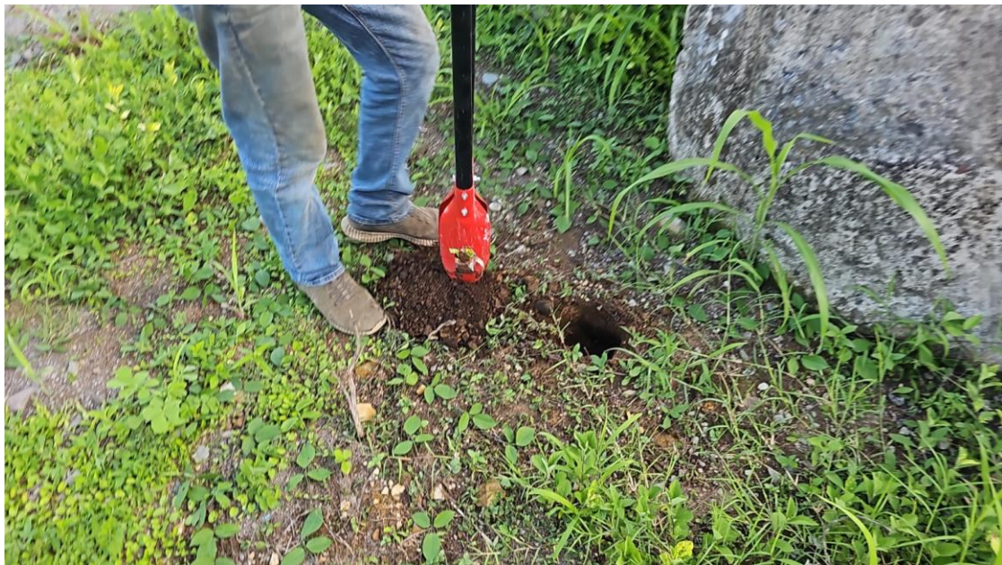
Fotos 1, 2, Excavación y caracterización de pozo de sondeo.
