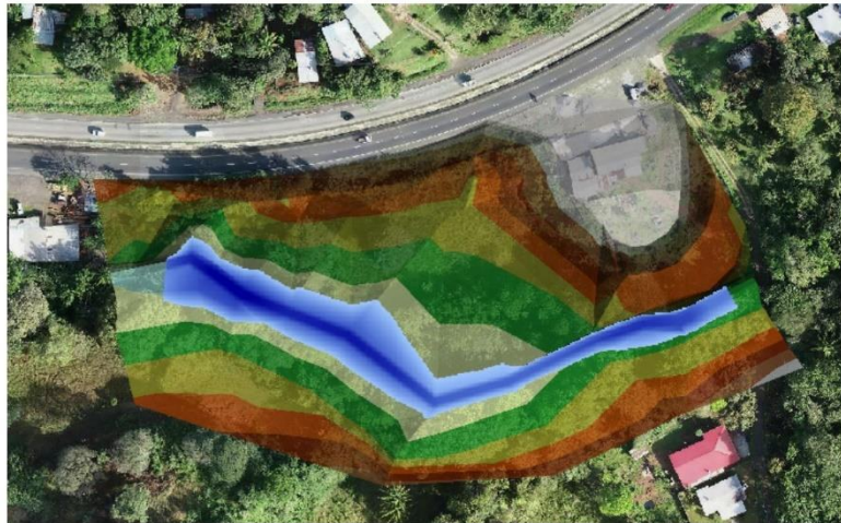
Ilustración 9. Planicie de inundación, condición original
