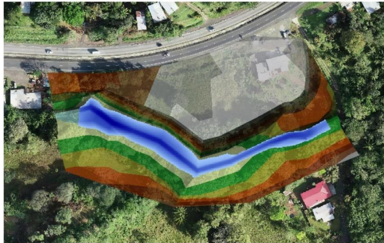
Ilustración 10. Planicie de inundación, condición futura
