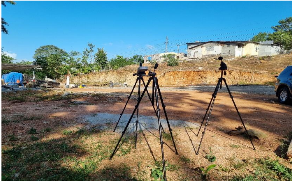
Figura 23. Equipo utilizado para las mediciones de ruido y calidad de aire
