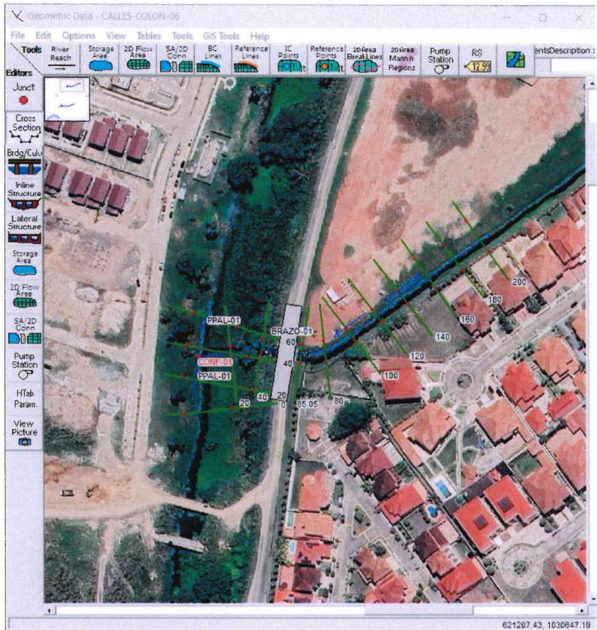
Imagen 5.1. 4-- Modelación hidráulica de cauce y puente proyectado en HEC-RAS
