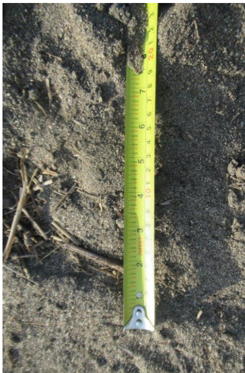
Arriba izquierda. Estrato superior del suelo franco-arenoso-limoso (FAL), inconsolidado. Derecha: roca ígnea que tiene muy poca presencia en el alineamiento del camino.
