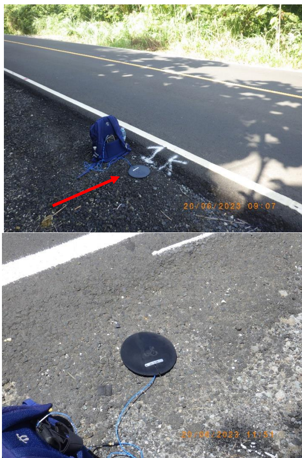
Imágenes 14.10.1 y 14.10.2. Equipo utilizado para medir vibraciones. Punto 1 y Punto 2, respectivamente
