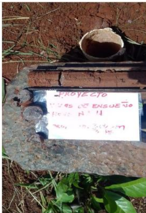
Fotos. DS410, DS411, DS412 Y DS413. Inicio de perforación, muestras de suelos extraídas a las profundidades 1.00, 2.00 y 3.00 metros.
