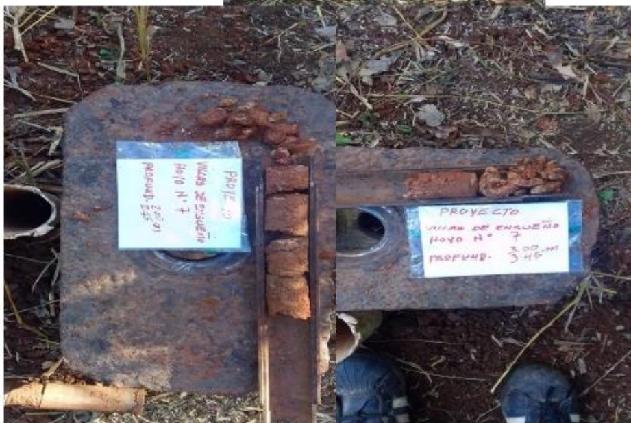
Fotos. DS710, DS711, DS712 Y DS713. Prueba SPT, muestras suelos extraídas a las profundidades 1.00, 2.00 y 3.00 metros.
