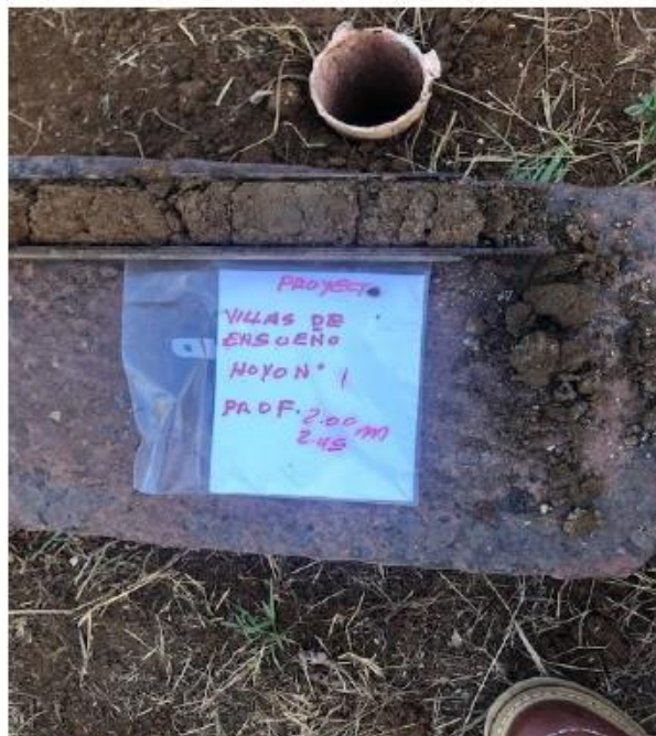
Foto No. E-2: Muestra de suelo para el ensayo de contenido de humedad natural. En bolsas plásticas rotuladas son llevadas las muestras al laboratorio donde se realiza el ensayo, para determinar la Humedad Natural del suelo, extraído.
