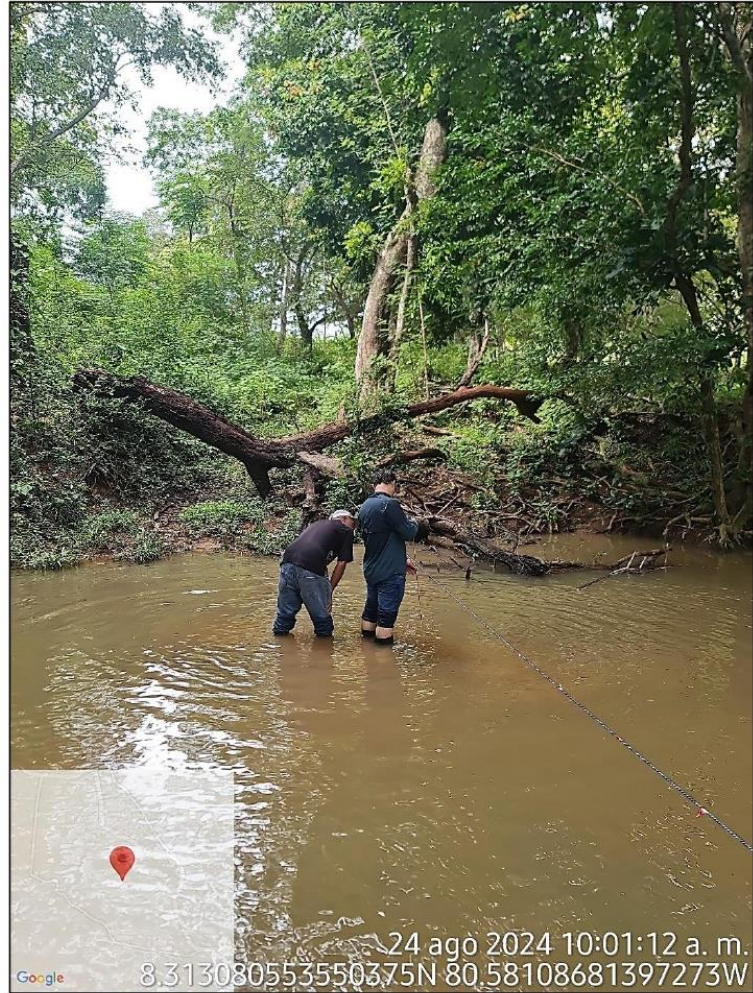
Ilustración 17: Levantamiento del lecho para el aforo por dron.
