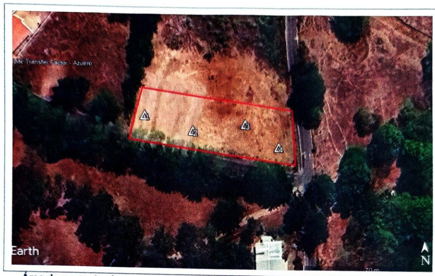
Área de proyecto vista en Google Earth y los sondeos efectuados y georreferenciados con sus respectivas coordenadas en el Sistema Geodésico Mundial (WGS 84).
