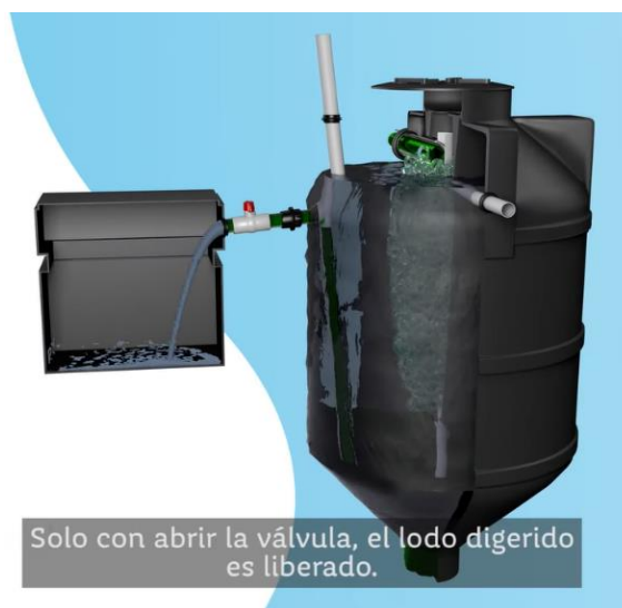
Figura 4.38. Sistema de Biodigestor Autolimpiable del Proyecto
