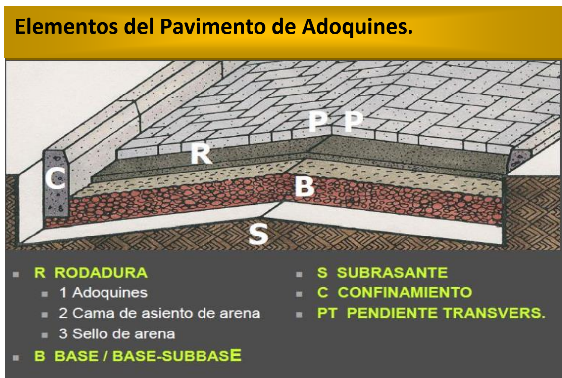
Figura 4.13. Elementos del Pavimento de Adoquines.
