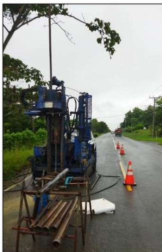
Ilustración 9 Equipo de perforación PS-40 Cummin, montada sobre orugas – Ejecución Barreno
