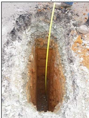
Ilustración 3. Excavación de apique (Calicata), dimensiones 0.80x2.00 m, este caso tenía 3 m de profundidad
