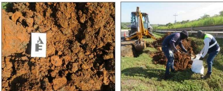
Ilustración 4 Toma de muestras de Calicatas
