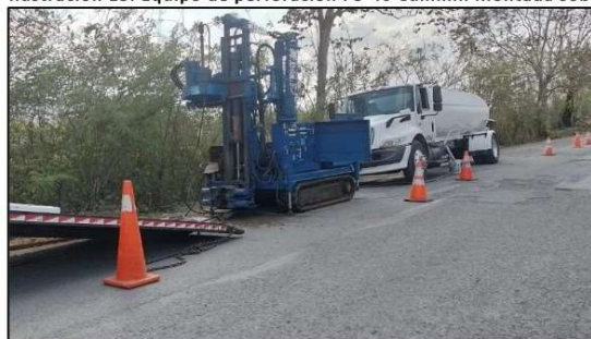
Ilustración 15. Equipo de perforación PS-40 Cummin Montada sobre orugas
