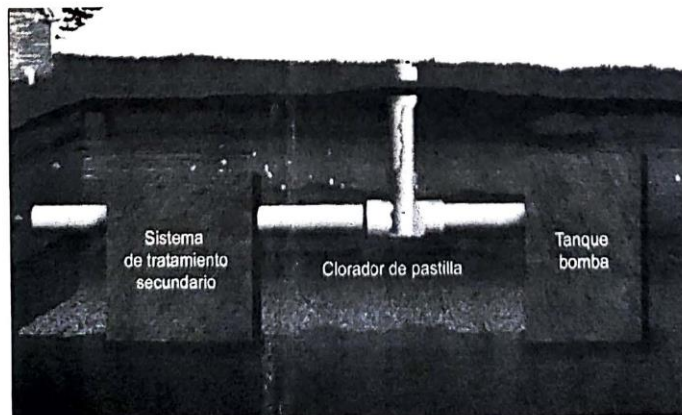
Figura 1: La manera más común de desinfectar los sistemas individuales es la cloración con pastilla.
