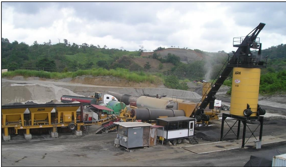
Imagen 2. Imagen ilustrativa de la planta de asfalto móvil modelo Asfhalt Drum Mixer. Modelo: RB-160
