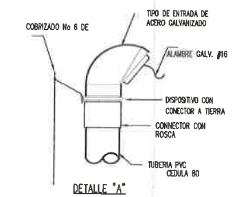
DETALLE "A" DETALLE DE TOMA DE SERVICIO AEREO PARA ACOMETIDA SUBTERRANEA
