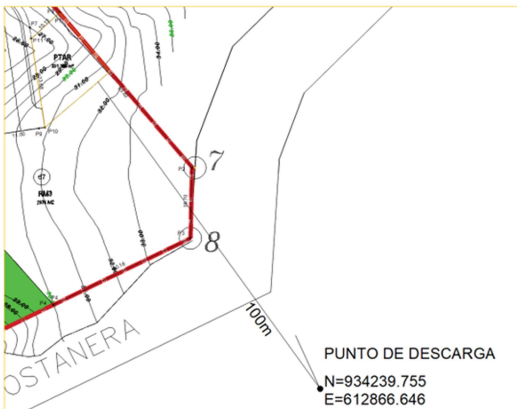
Figura N°2: Punto de Descarga
