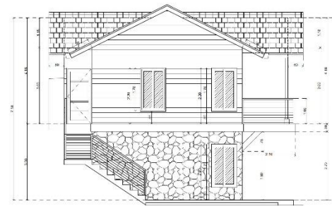
ELEVACIÓN LATERAL E1-04 - CABAÑA TIPO A1 Y A2 ESCALA 1:50
