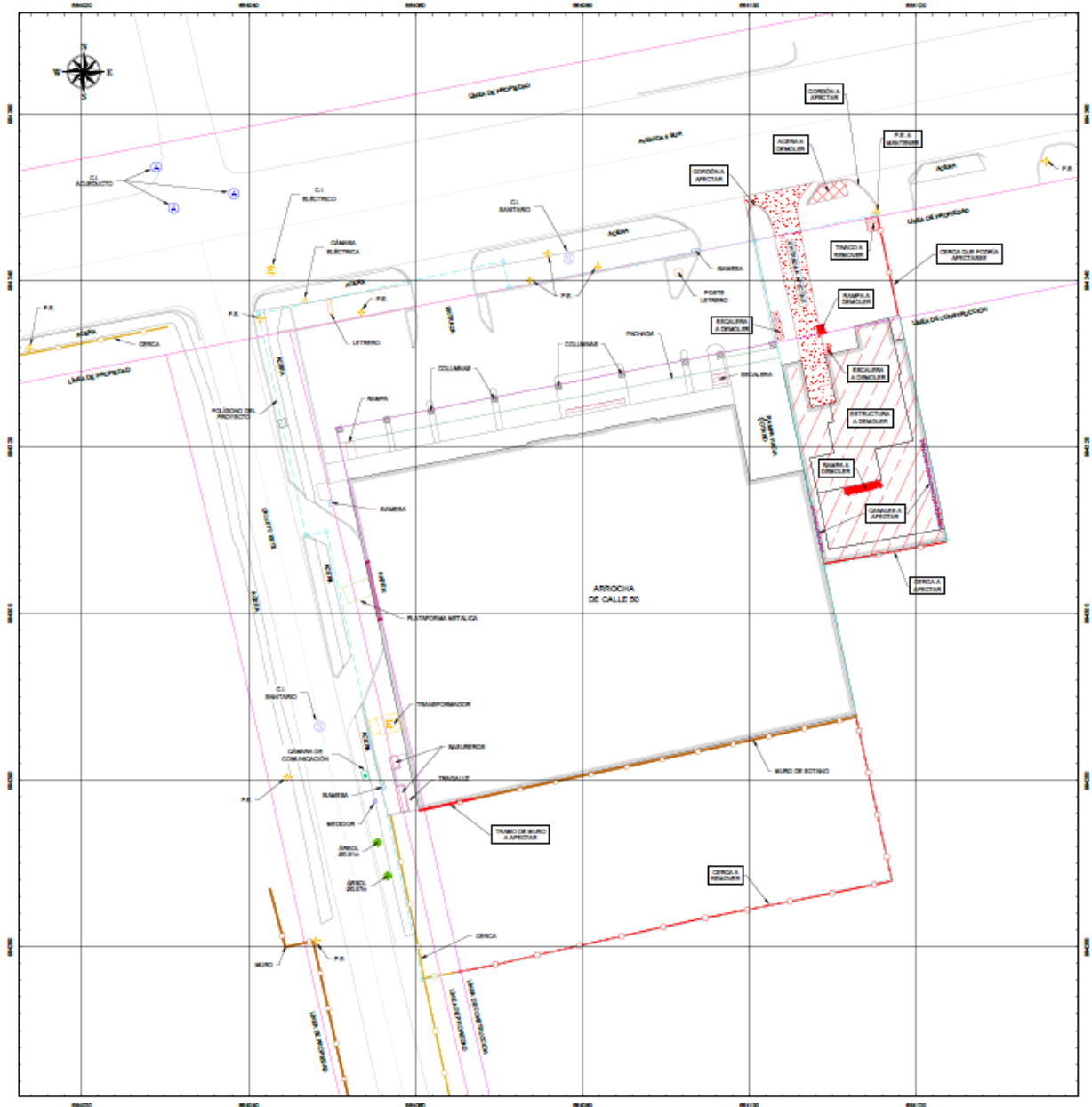
PLANTA DE CONDICIONES EXISTENTES Y DEMOLICION
