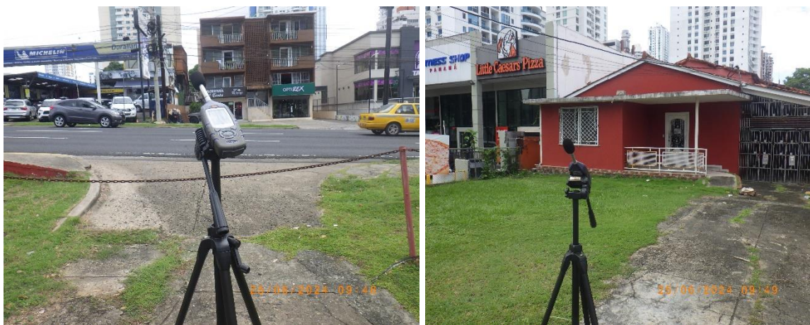
Imágenes 2 y 3. Vistas del sonómetro durante las mediciones de ruido ambiental
