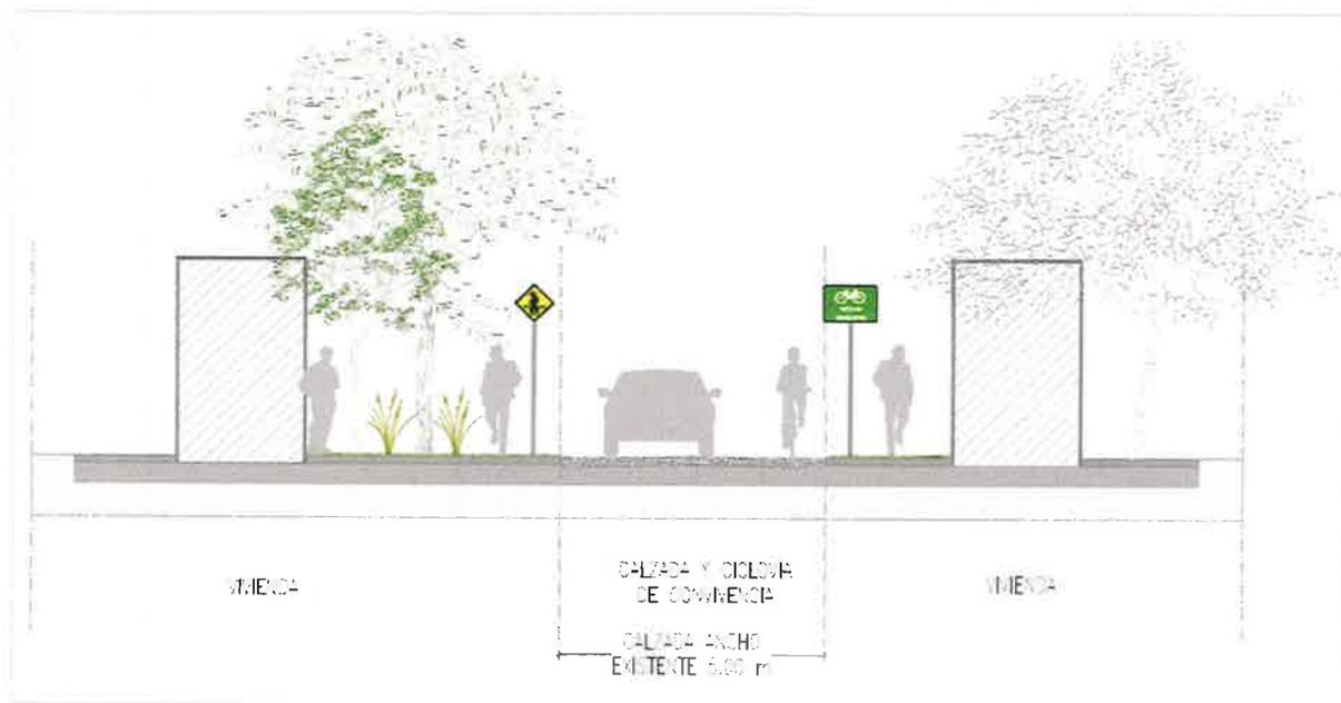
**Figura 11. Detalle 2 Corte en calle vía El Arenal de bicisenda de dos carriles por sentido y vereda en ambos lados (Progresivas 0+640 a 1+120 – 1+900 a 2+125) sentido hacia la playa**
