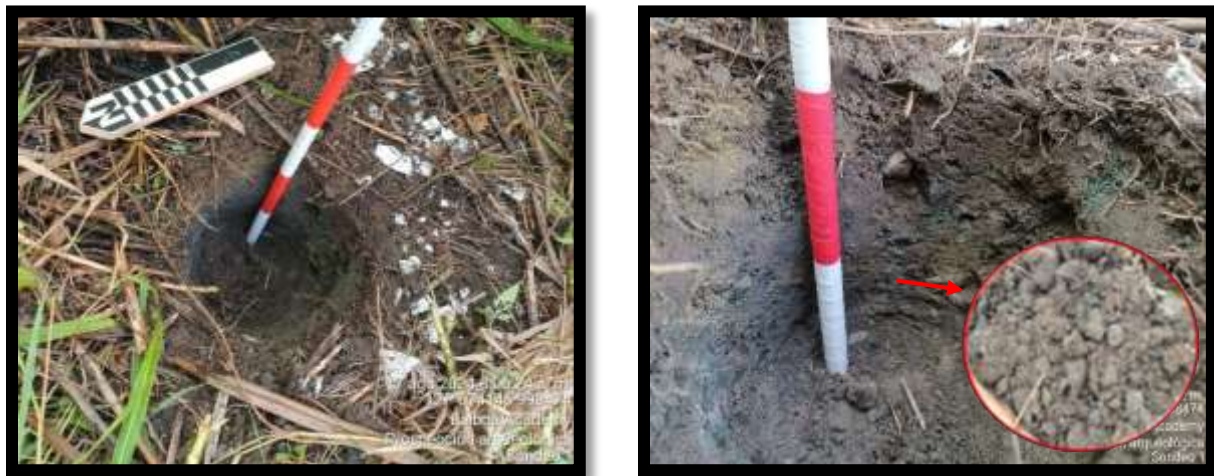
Fotografía 10 y 11. Sondeo 1 donde se evidencia la alteración de los rellenos en el subsuelo
