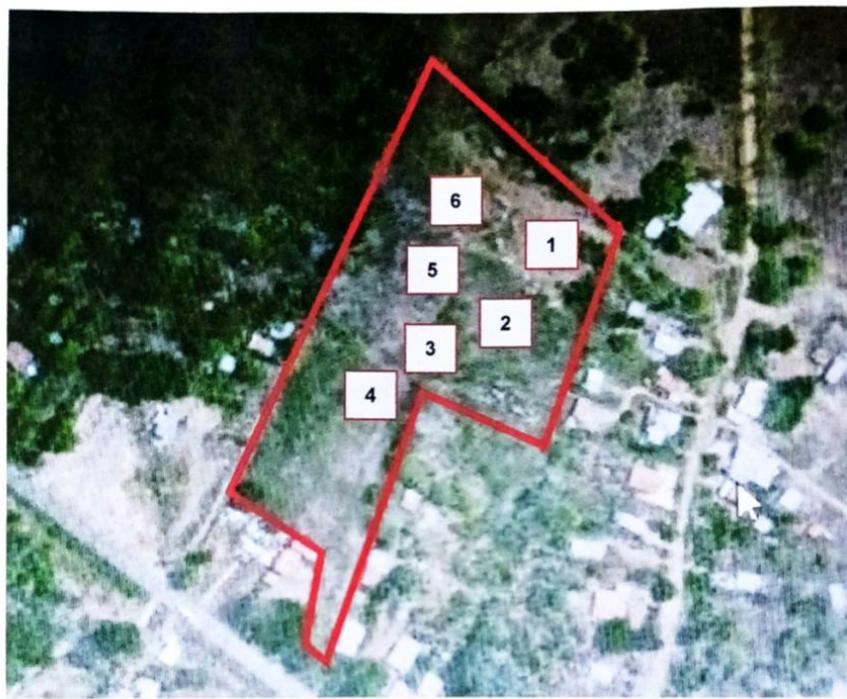
Área de proyecto vista en Google Earth y los sondeos efectuados y georreferenciados con sus respectivas coordenadas en el Sistema Geodésico Mundial (WGS 84, Zona 18).
