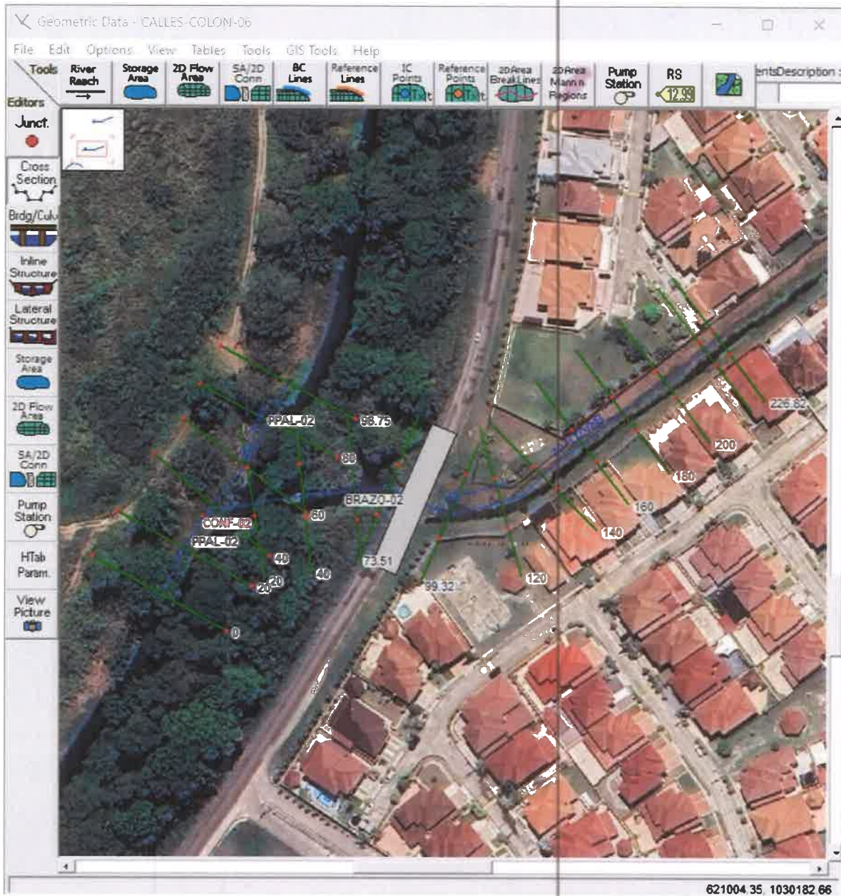
Imagen 5.1. 4— Modelación hidráulica de cauce y puente proyectada en HEC-RAS
