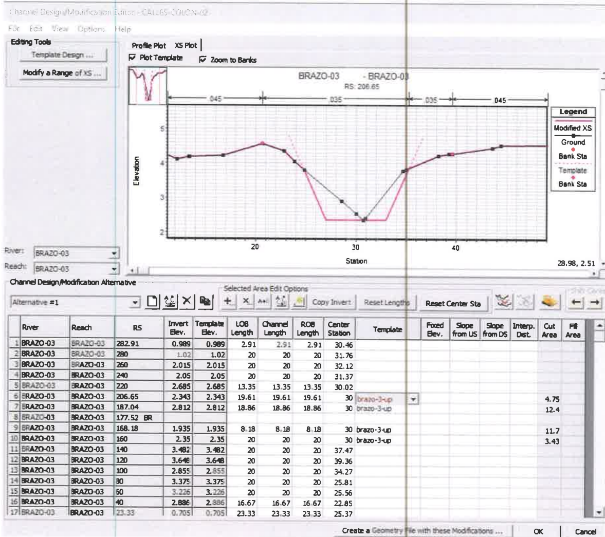
Imagen 5.1. 6 – Modificación de cauce en puente (taludes de protección)
