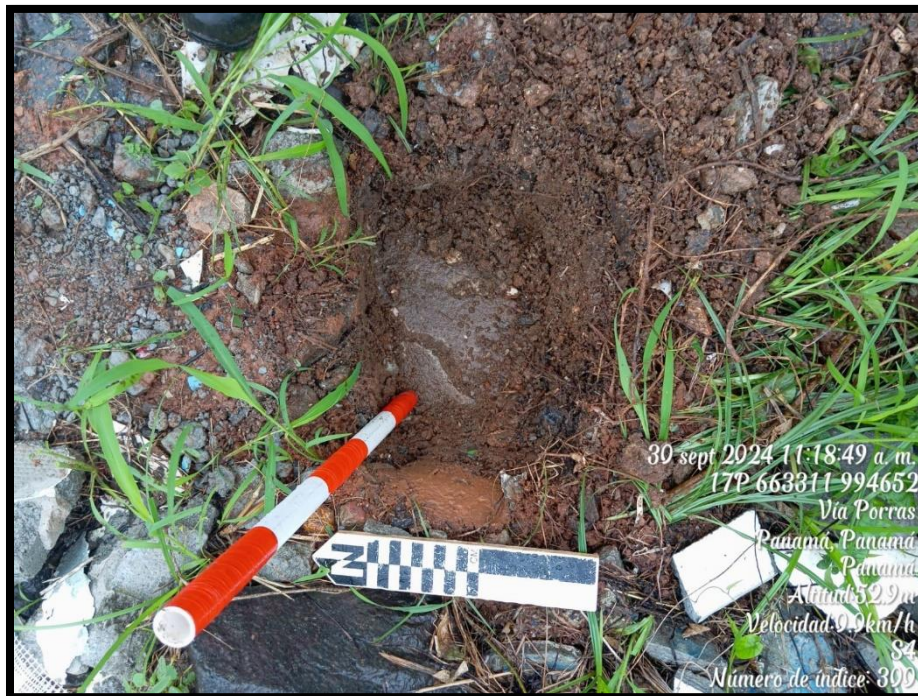
Fotografías 6. Sondeo donde se observa el recubrimiento de cemento a menos de 10 cm de profundidad.
