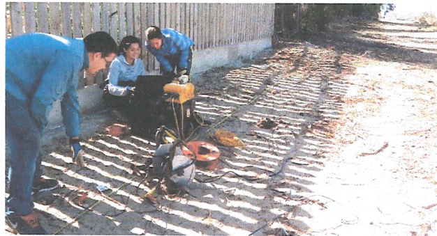
Ilustración 6: Medición equipo sismográfico de 24 canales
