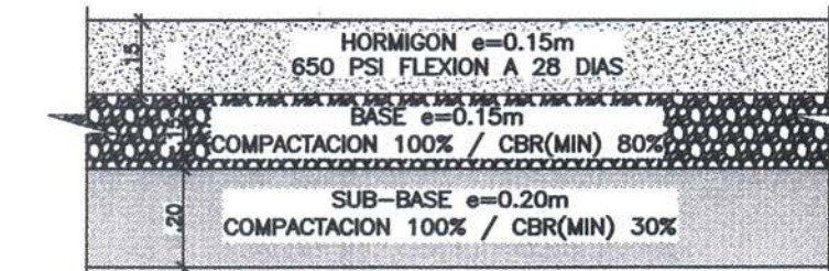
DETALLE DE PAVIMENTO EN HORMIGON
