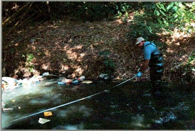
Fotos N°1 y N°2 – Levantamiento de la sección transversal y medición de la velocidad con molinete hidráulico
