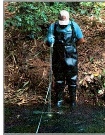
Fotos N°1 y N°2 – Levantamiento de la sección transversal y medición de la velocidad con molinete hidráulico
