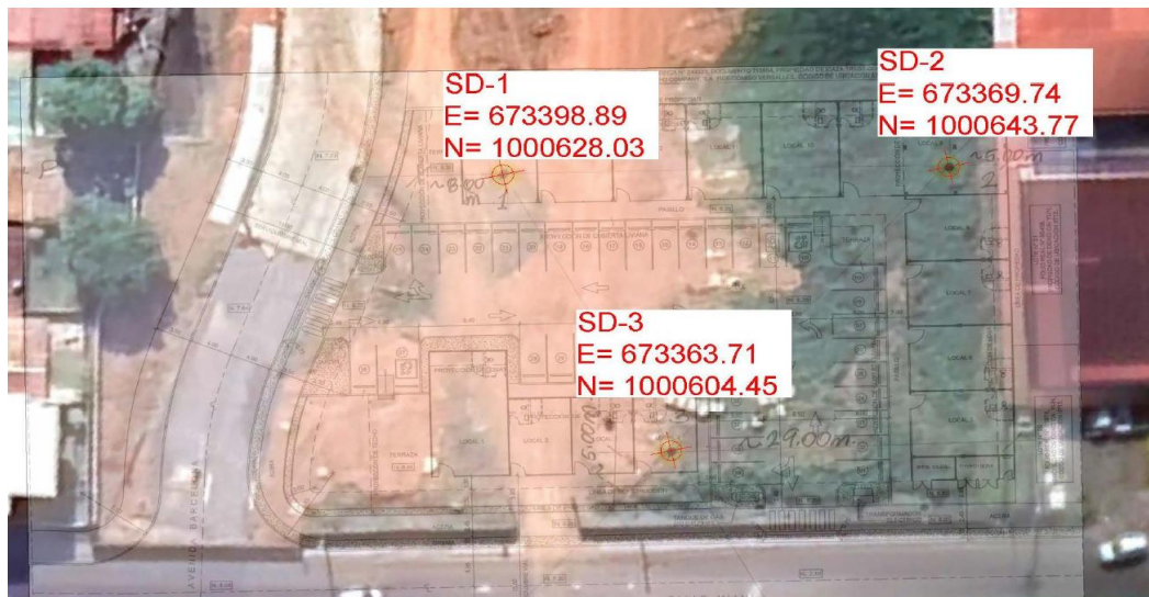
Figura N° 5.1 Sondeos de Investigación de suelos_Proyecto Cantabria Shops
