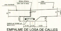
EMPALME DE LOSA DE CALLES
