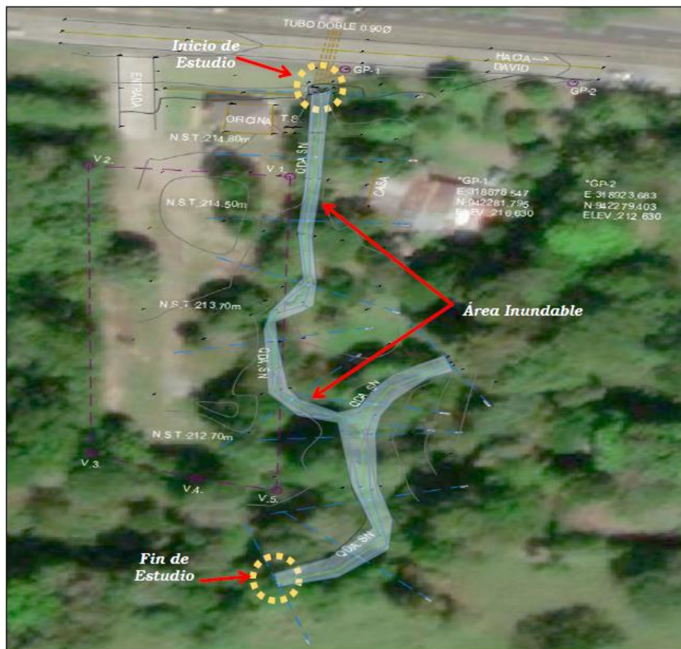
Figura 2. Planta de Área Inundable del Cauce, colindante al Proyecto, Simulación de Crecida con Programa Hec-Ras Nivel de Aguas Máximas Extraordinarias en Planta. *N.S.T.=Nivel Seguro de Terracería, T.N.: Terreno Natural.
