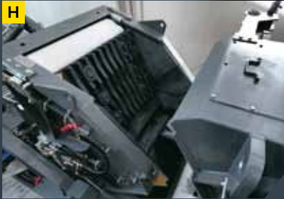
Trituradora La trituradora de impacto de RUBBLE MASTER resulta muy atractiva por su bajo coste de desgaste y su elevada productividad. También por su sistema de liberación integrado y sus palancas de rápida liberación, que reducen al mínimo los tiempos de parada.
