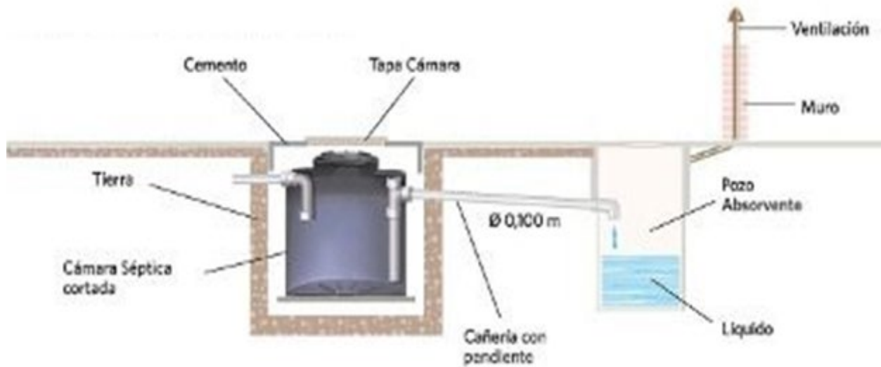
Ilustración 6. Detalle Típico del Sistema de Tanque Séptico
