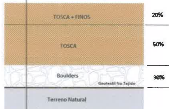
Figura 3 - Sección del relleno
