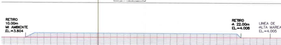
Figura 2 - Sección referencial para el relleno
