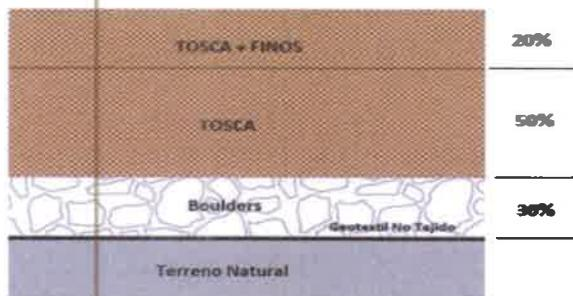
Figura 3 - Sección del relleno
