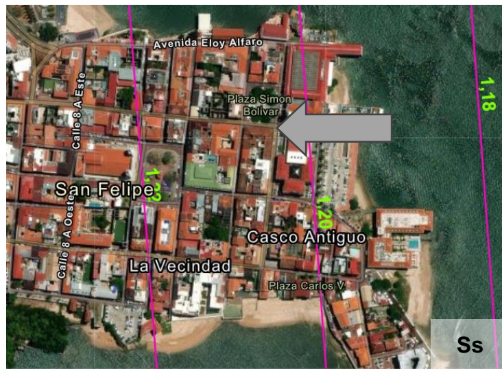
Aceleración Espectral 0.2 seg ( S_s )/5% de Amortiguamiento Crítico de 1.22g.
