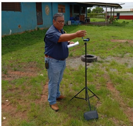
Foto 1. Medición de calidad de ruido ambiental en el polígono del proyecto
